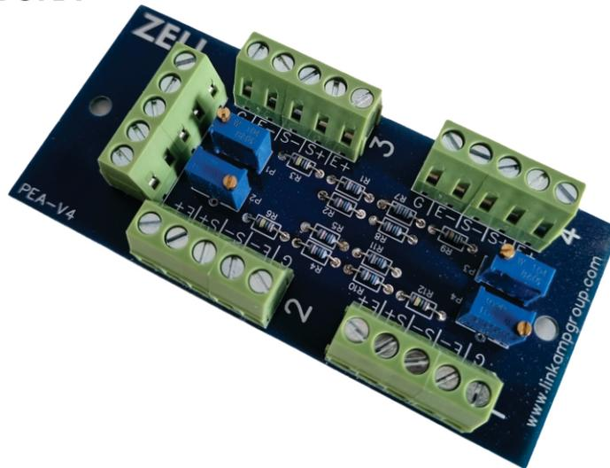
Placa sumadora y ecualizadora para celdas de carga analógicas. Permite la conexión de hasta 4 celdas. Ajuste mediante atenuación de la señal.
