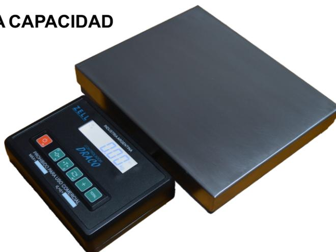
Plataforma de baja capacidad, disponible en diferentes capacidades. Construida en acero al carbono y pintura epoxi horneada con cubierta de acero inoxidable AISI304 (opcional, construcción íntegra en acero inoxidable). Celda de carga de alta resolución, patas regulables con base de goma antideslizante. Indicador en gabinete plástico ABS. Fácil instalación y uso.
