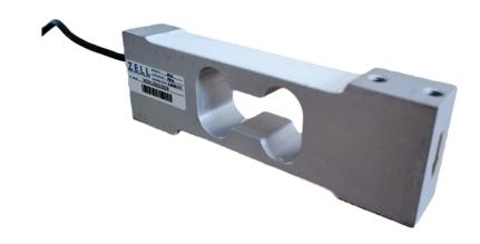
Monocelda de aluminio con tratamiento de anodizado, diseñada con estructura de viga en voladizo. Acepta cargas torsionales. Su diseño y ajuste de esquinas durante su fabricación, garantizan una excelente excentricidad. Apta para aplicar con receptores de cargas de hasta 400 x 400 mm.
