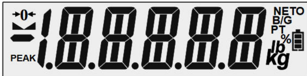
El display es de cristal líquido con backlight blanco, tiene 5 1/2 dígitos de 19mm y varios íconos indicadores. El rango de indicación posible es de 199999 a -199999. Es de fácil lectura en todas las condiciones de iluminación, tanto en la oscuridad como a plena luz del sol.
