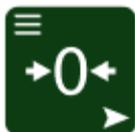
En el modo de peso Bruto (B/G), si el display no muestra Cero con la plataforma vacía, puede ajustar a Cero el peso dentro de +/- 1/4 de división pulsando <zero>. El rango de acción predeterminado de esta tecla es +/- 1,9% de la Capacidad máxima. La tecla <zero> no afecta la capacidad del instrumento. Si el peso no es estable al pulsar <zero>, el display muestra [-----] hasta llegar a equilibrio.
