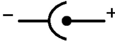
La tensión de alimentación admitida es de entre 5 y 15VCC. Se recomienda utilizar una fuente switching de 9V 0,5mA.
