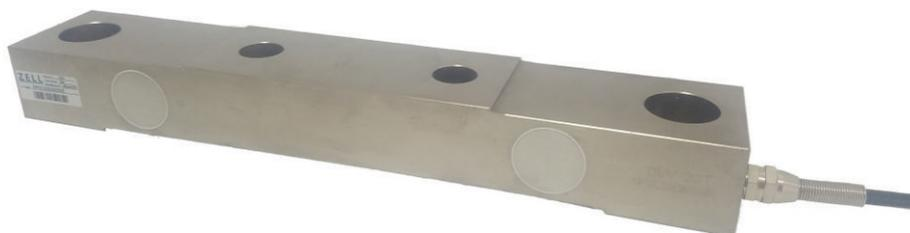
Celda de carga tipo doble viga a la flexión. Construida en aleación de acero con acabado superficial niquelado. Grado de protección IP65. Se destaca su versatilidad y facilidad de instalación. Además su diseño permite la utilización en una diversidad de aplicaciones en el agro como autodescarbles, mixers, tolvas, silos, etc.
