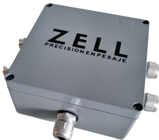
Caja de unión de aluminio inyectado. Protección IP65. Permite la conexión y ajuste de señal de hasta 4 celdas. Aplicable en plataformas, tolvas, silos y demás balanzas con mas de una celda.
