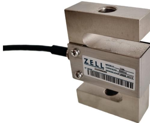
Celda de carga tipo "S", construida en aleación de acero o acero inoxidable. Su diseño permite utilizarla tanto a la tracción como a la compresión con una excelente simetría de salida. Posee un cuerpo compacto de fácil instalación y una amplia gama de aplicaciones. Ideal para balanzas híbridas, tolvas de baja capacidad, cargas suspendidas, pesaje a la compresión y maquinas de ensayos y/o ciclados, etc.
