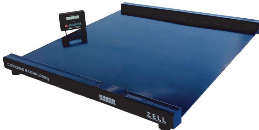
Balanza de bajo perfil, disponible una variada combinación de dimensiones y capacidades. Construida en acero al carbono y pintura epoxi horneada o acero inoxidable AISI304. Celdas de carga de alta resolución, patas regulables con base de goma antideslizante. Controlador Draco en gabinete plástico ABS. Fácil instalación, Ideal para pesaje de palets. Fácil acceso mediante zorra hidráulica.
